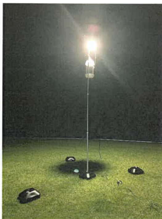
写真2. LED照明直下にFITを設置した
