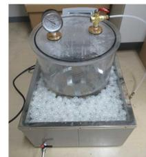
図-2 脱気水槽と恒温槽(本支援基金により購入)
