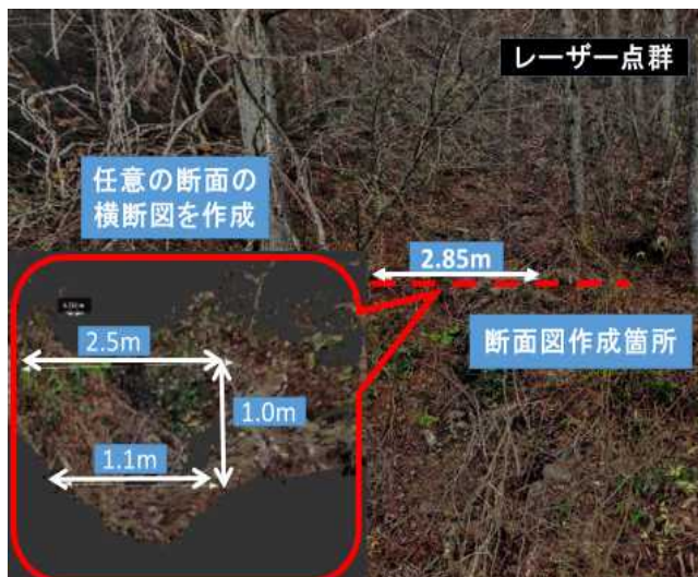
図-5 侵食（ガリー一部）の計測結果
