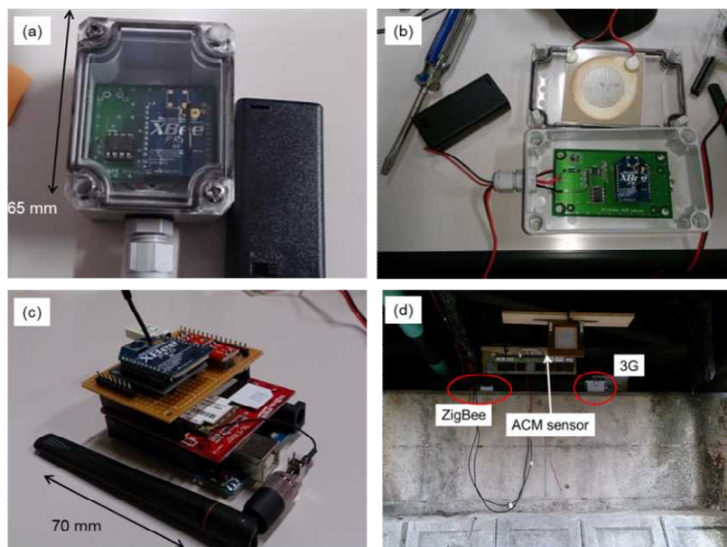
図-1 (a)・(b) 無線式損傷記憶センサ, (c) 温・湿度センサ付き 3G 中継器, (d) 橋梁裏への設置
